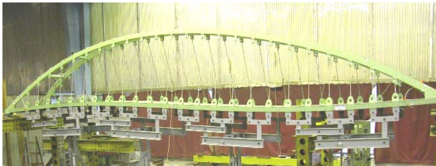
10. ábra: Az igen erősen deformálódott alak a féloldalas terhelésnél
